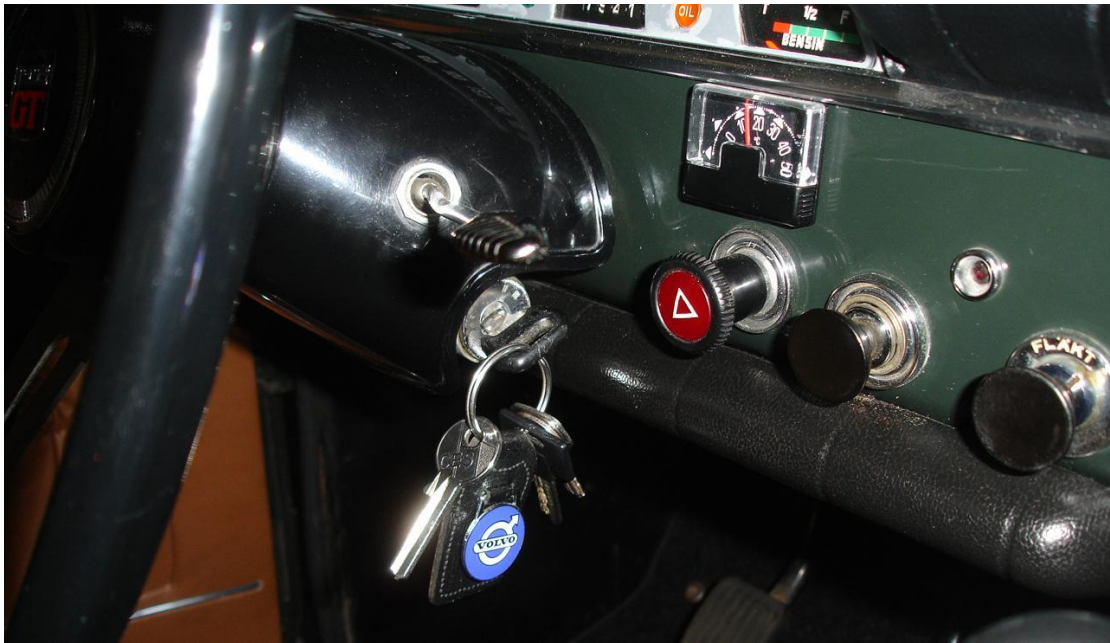
Eftermonterad varningsblinkers, 1969 123 GT (detaljnummer okänt)
