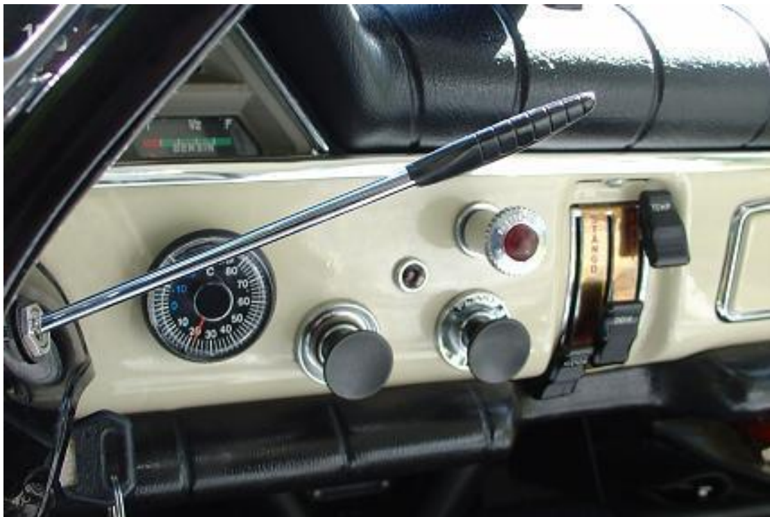
Eftermonterad varningsblinkers, tillbehör (detaljnummer 279901) The Roberk Co. Model 800
