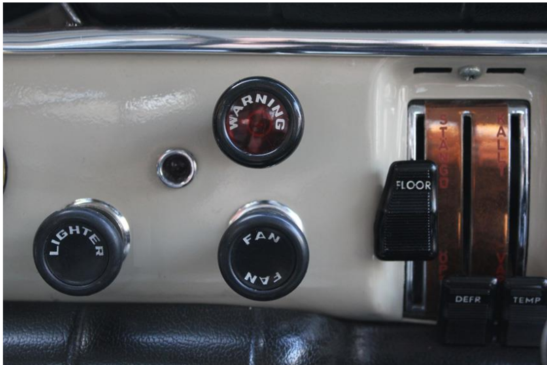
Fabriksmonterad varningsblinkers, 1968 122 s i exportutförande (detaljnummer 673380)
