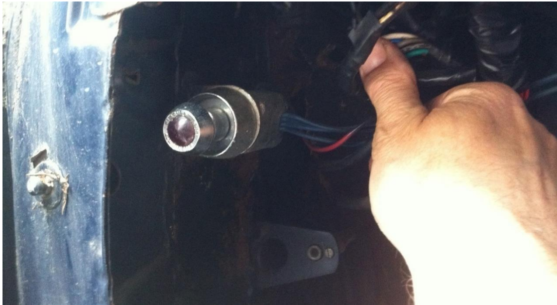
Fabriksmonterad varningsblinkers, 1967 Canadian GT (detaljnummer okänt)
