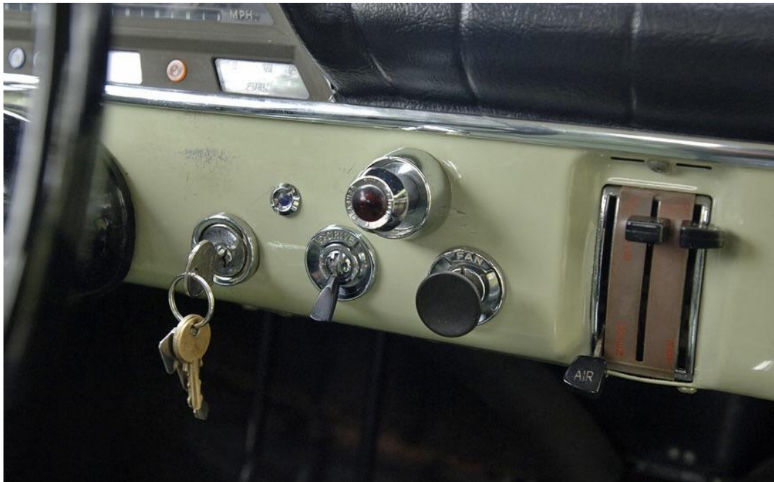
Eftermonterad varningsblinkers, 1966 122 s (detaljnummer okänt)
